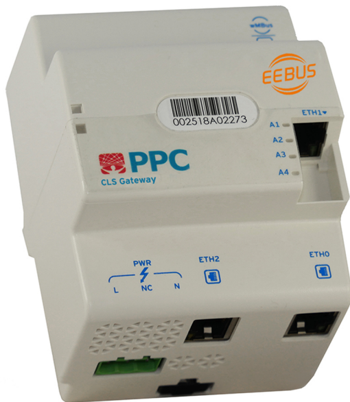
Abb. 1: Das CLS Gateway von PPC mit EEBUS-Erweiterung
